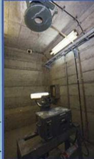
水圧や地盤の変形などにより、ダム堤体に生じるひずみを測定し、ダムの安全性をチェックする計器です。ダム上部からおもりを吊ったノーマルプラムラインと、岩盤からワイヤーを引っぱり上げたリバースプラムラインがあります。
